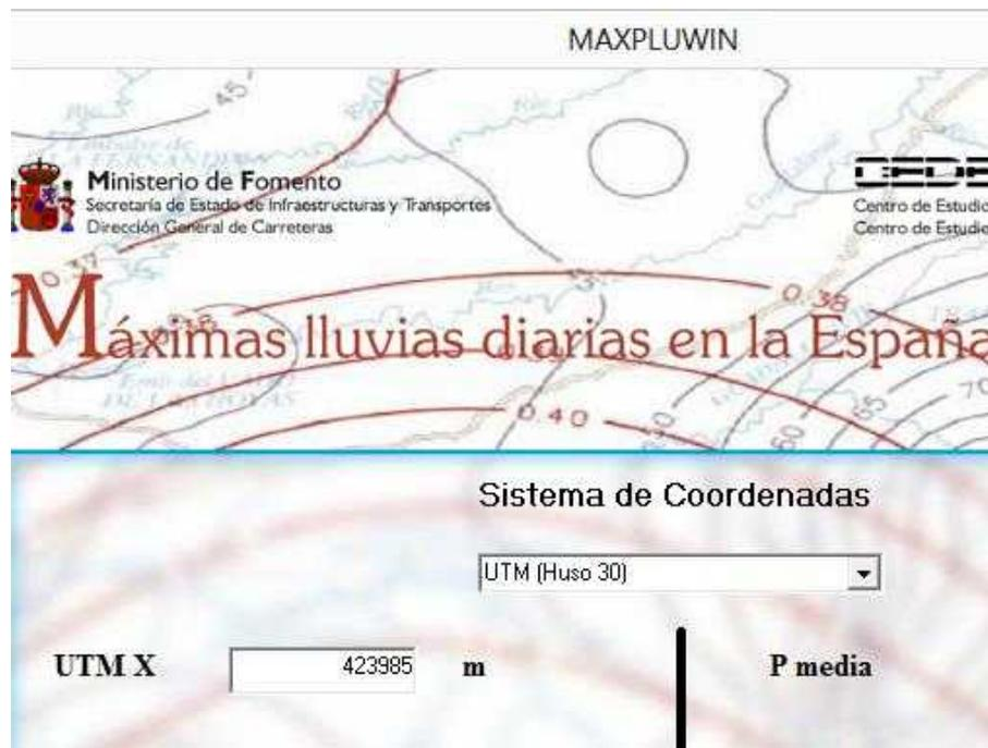
Figura 3: Interfaz para la introducción de datos del programa MAXPLU.
