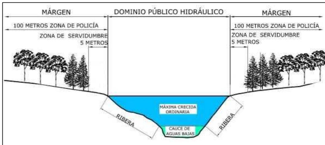
Figura 5: Esquema del DPH.
