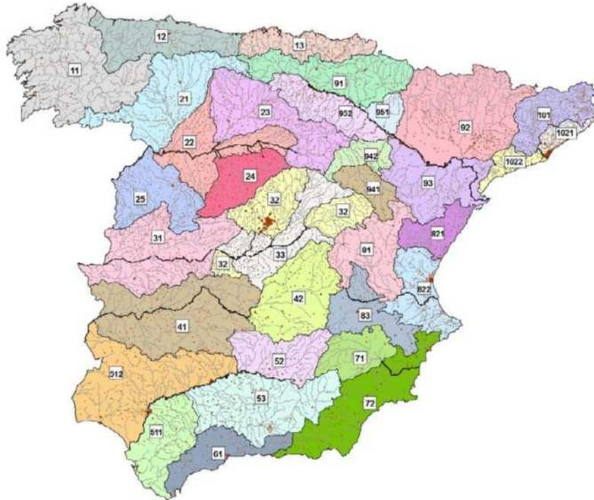
Figura 7. Regiones consideradas para la caracterización del coeficiente corrector del umbral de escorrentía (Figura 2.9 de la I.C.-5.2)
