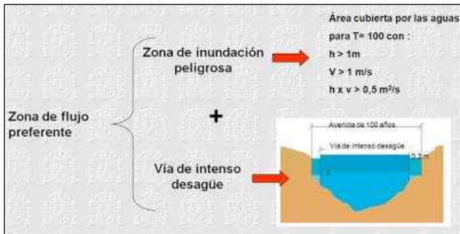
Figura 9: Esquema del cálculo de la zona de flujo preferente.
