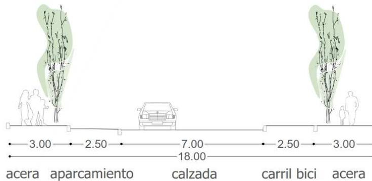
Figura 9. Sección tipo 5 en vial de 18,0 m
