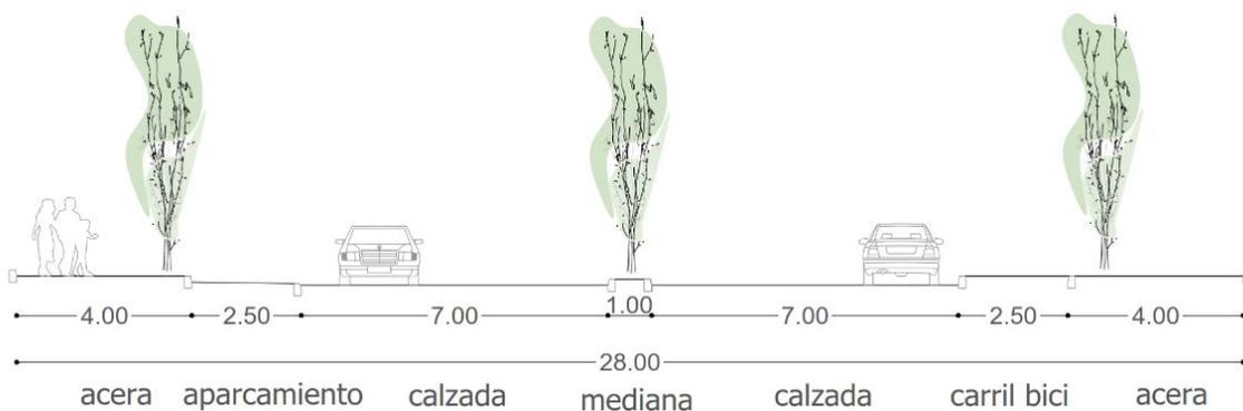
Figura 5. Sección tipo1 en vial de 28,0 m
