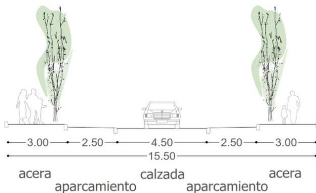
Figura 7. Sección tipo 3 en vial de 15,5 m
