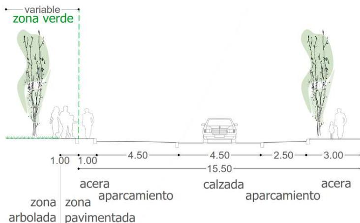
Figura 8. Sección tipo 4 en vial de 15,50 m
