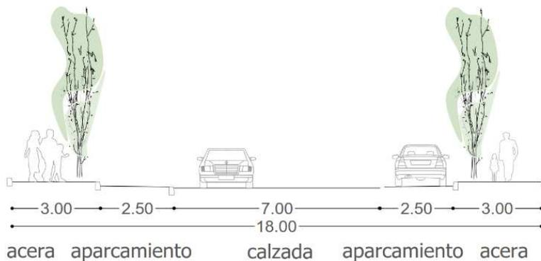
Figura 6. Sección tipo 2 en vial de 18,0 m
