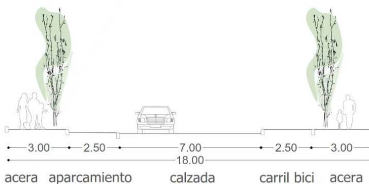
Figura 43. Sección tipo 5 en vial de 18,00 m
